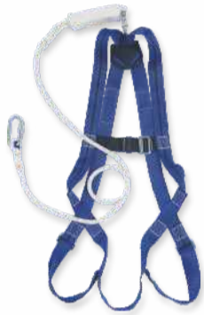
Set antichute TITAN: - EN 361 - Harnais 1 point - Longe de 2 mètres avec absorbeur de choc - 2 mousquetons à vis Réf.: 1011896
