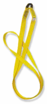
Cravate d'ancrage: - EN 795 B (1996) - Sangle polyester - Résistance à la rupture > 10 kN Réf.: 1031460 (longueur 0,8 M.) 1031461 (longueur 1,5 M.)
