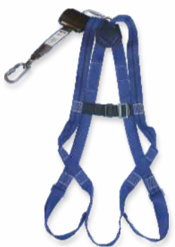
Set construction TITAN: - EN 361 - Harnais 1 point - Enrouleur à rappel automatique de 2,5 mètres Réf.: 1011898
