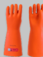
Gants isolants avec protection mécanique et Arc-Flash ATPV 12 cal/cm 2 , APC 2 Classe 0 (1000 V) Réf: CGM-0
