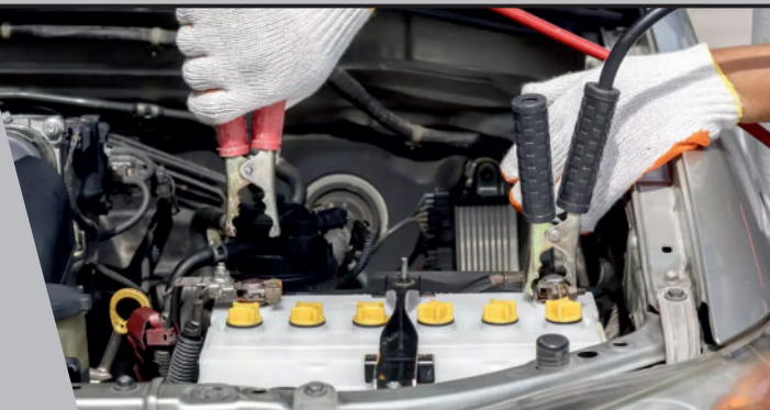
CÂBLES DE DÉMARRAGE
