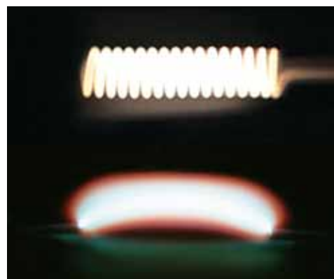
Filament d'une lampe halogène par rapport à l'arc électrique d'une lampe XENARC®.
