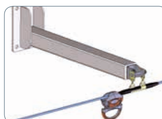
Passage automatique sur pièce intermédiaire
