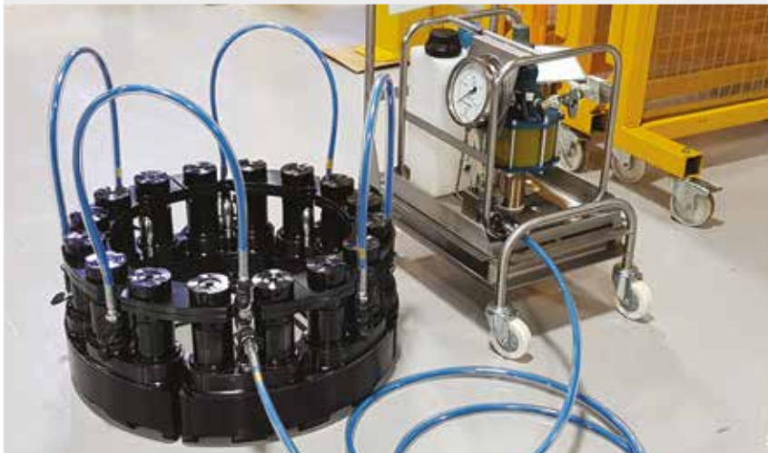
▲ Installation de la mise en tension multigoujon.
