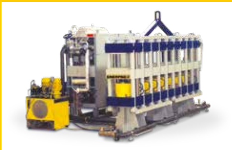
◀ Presse entièrement automatique de haute précision à automate (1800 tonnes). Le cycle de pressage et de chauffage, lors de la production de bobines d'accélération magnétiques, nécessite une grande force et une grande précision pour garantir une qualité absolue.
