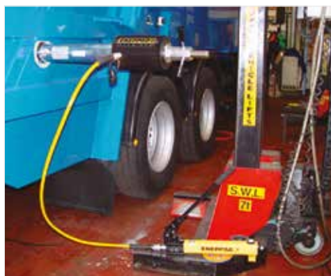
◀ Un vérin RACH306 alimenté par une pompe à main P392 est utilisé pour extraire une goupille corrodée dans une benne à déchets.
