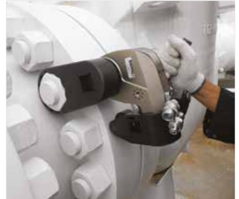
▲ Clé dynamométrique S11000X personnalisée au moyen d'un manchon de serrage et d'une roulette de réaction.
