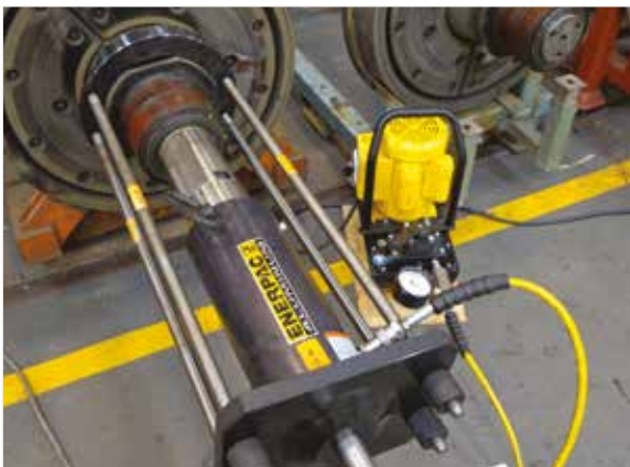
◀ Traction de roue de rail à l'aide d'un vérin en aluminium RACH alimenté par une pompe de la série ZE.
