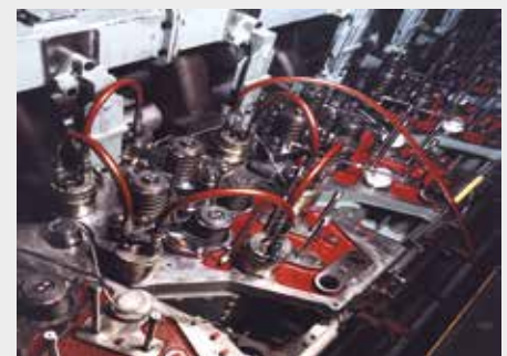
▲ Écrous hydrauliques sur moteur diesel
