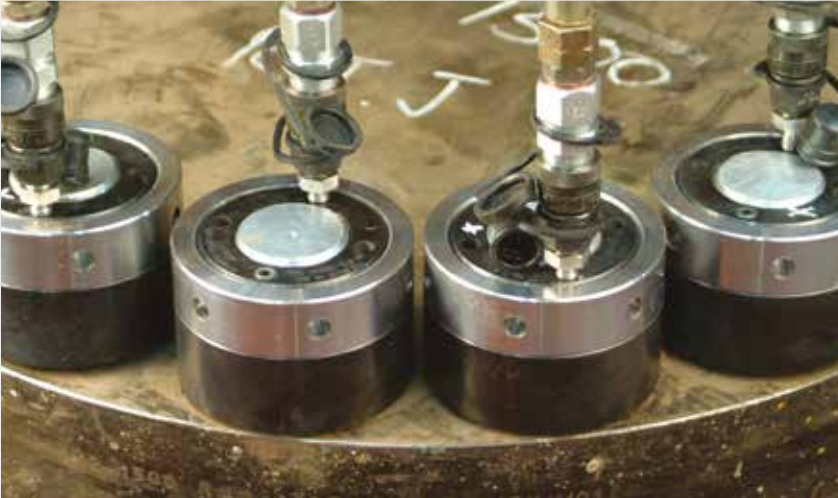
▲ Mise en tension avec écrous hydrauliques
