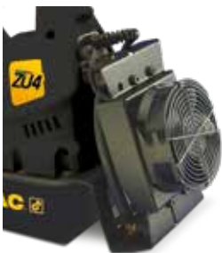
Refroidisseur (H) • Refroidit l'huile de dérivation • Augmente la durée de vie de l'huile et réduit l'usure des composants hydrauliques.
