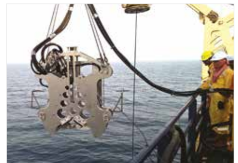
▲ Scie à fil diamanté MDWS immergée dans l'eau.
