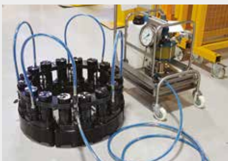
◀ Système Enerpac de mise en tension multigoujon (MST) permettant de serrer tous les goujons d'un joint en même temps.
