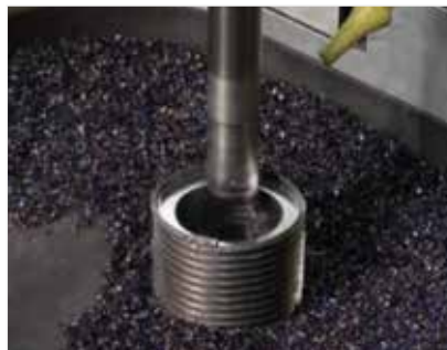
▲ Noyautage du centre d'un boulon (diamètre intérieur).
